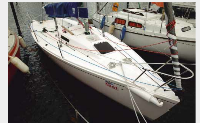
Keine Klampen – die Festmacher müssen mühselig an einem Decksauge und am Heckkorb belegt werden
