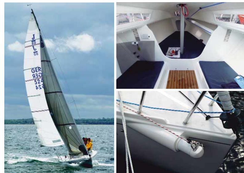
Mit halbem Wind über sieben Knoten. Auffallend sind der schlanke Rumpf und die große Segelfläche. Oben: Spartanisch – vier Polster im „Wohnbereich“, durchquert vom eingezogenen Gennakerbaum. Unten: Lagerung des Baums am Bug
